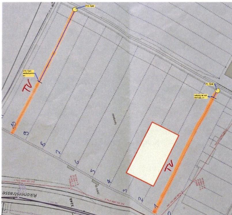
Bei der letzten Spülung der einzelnen Drainageleitungen im November 2024 wurde festgestellt, dass beim Hauptplatz Nr. 1 bei zwei von elf Leitungen der Abfluss infolge Verstopfungen und starken Senkungen nicht mehr gewährleistet ist. Die genauen Stellen konnten mittels Kanal-TV lokalisiert werden. Die beschädigten Leitungen sind im Plan orange markiert. Gleichzeitig wurde festgestellt, dass im Torraum ca. 100 m<sup>2</sup> Rasen durch Krähen beschädigt wurden.
