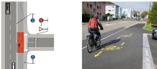
Abbildung 3: Variante Zweirichtungsradweg und Fuss-/Radweg gemäss Velostandards
