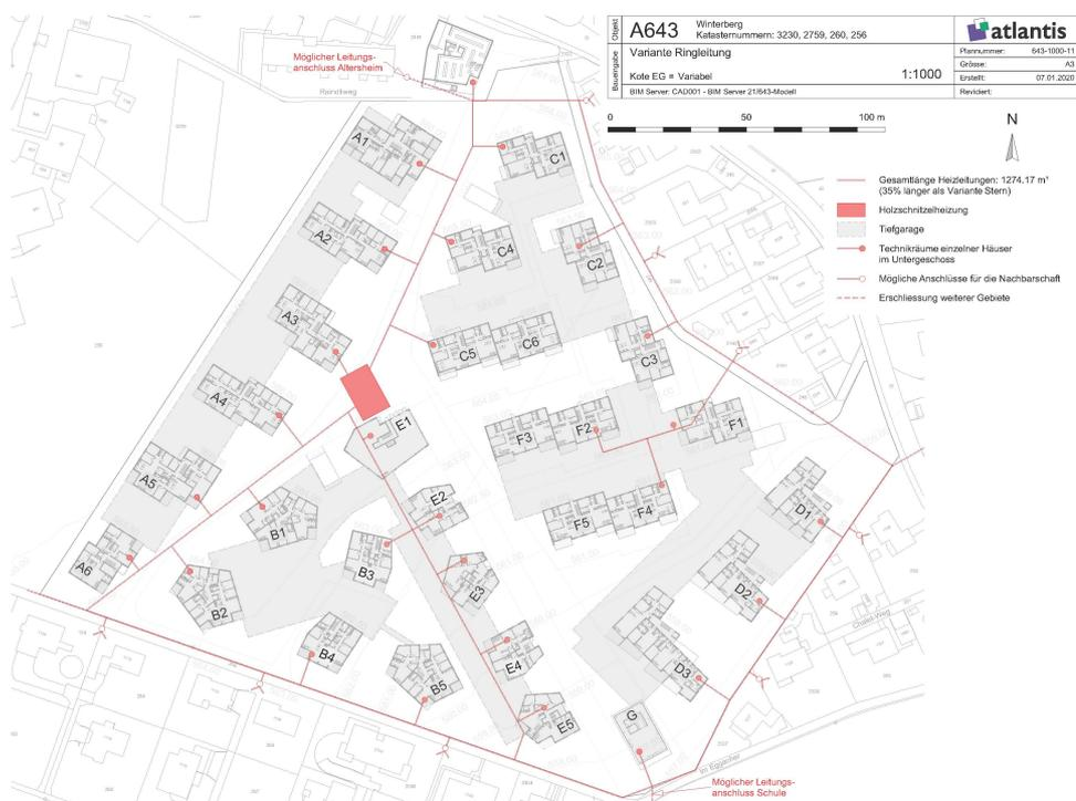
Bild 2: Ringförmiges Erschliessungsnetz
