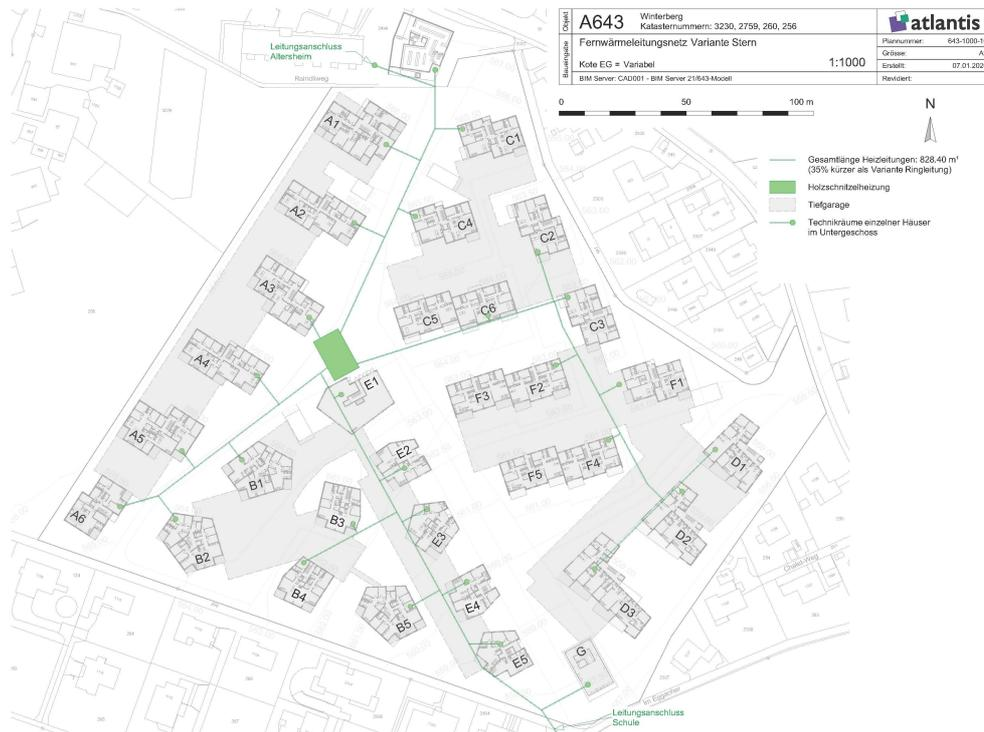
Bild 1: Sternförmiges Erschliessungsnetz
